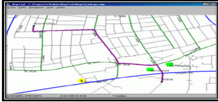
Şekil 3.2: İki dağıtım noktası arasında rota optimizasyonu
