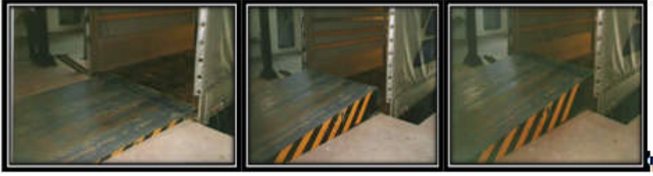
Resim 2.3: Sabit rampa çalışma sistemi
