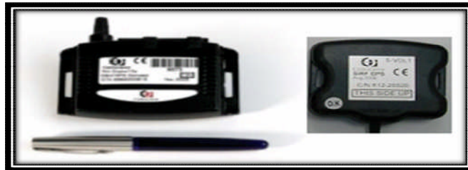
Resim 3.1: Araç takip cihazları ( GPS alıcı ve GPRS modem )
